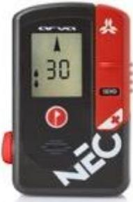
C'est un appareil électronique émetteur d'un signal radio destiné à localiser son porteur, si celui-ci est victime d'une avalanche. L'appareil dispose de deux modes :
